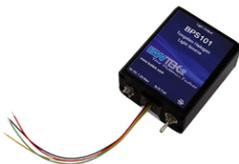
BPS101 - это оптоволоконный источник света постоянного тока, который обеспечивает точное управление током и стабильную производительность. Он оснащен разъемом SMA 905 для оптоволоконной муфты без необходимости дополнительного выравнивания волокна. Этот вольфрамовый галогенный источник света имеет спектральную мощность от 350 нм до > 2600 нм, что делает его идеальным для видимых и NIR-спектроскопических применений.
