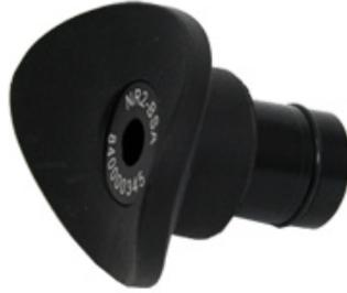
NR2-BSA - это адаптер для бутылок для портативного рамановского спектрометра NanoRam и NanoRam-1064. Он оснащен изогнутым световым экраном, чтобы уменьшить помехи от окружающего освещения. Кроме того, адаптер для бутылок имеет большее рабочее расстояние, позволяющее лазеру фокусироваться глубже в контейнере, смягчая помехи от толстых контейнеров.
